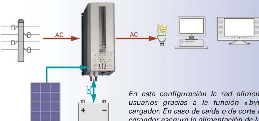
En esta configuración la red alimenta directamente los usuarios gracias a la función «bypass» del inversor-cargador. En caso de caída o de corte de la red, el inversor-cargador asegura la alimentación de los usuarios.
